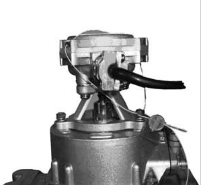
Рис.2. Пломбировка генератора импульсов
