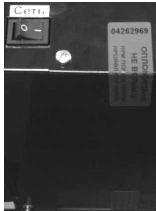
Рис.4. Пломбировка корпуса блока управления
